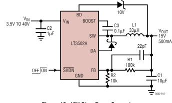
Figure 12. 15V Step-Down Converter
